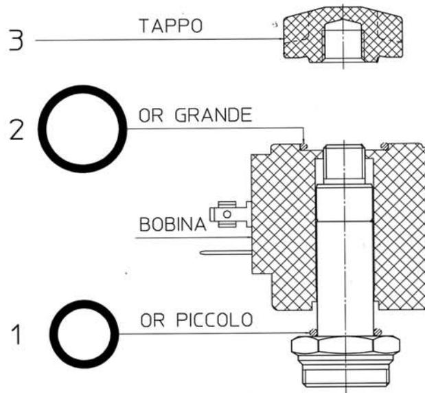
Ordine di assemblaggio: 1 - Bobina - 2 - 3
