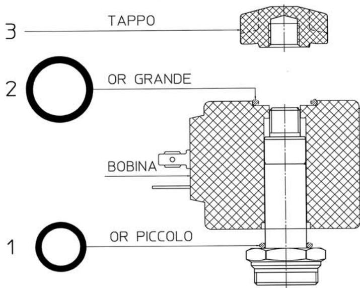
Ordine di assemblaggio: 1 - Bobina - 2 - 3
